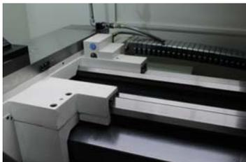
Zur Standardausstattung der FCL-H-Maschinen gehören Komponenten wie zum Beispiel Hochpräzisionsspindeln, Hochgenauigkeits-Kugelgewindespindeln, schwere Guss-Reitstöcke und verschleißfeste Führungsbahnen.
